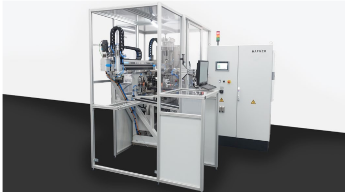
El equipo de medición para carcasas de compensación mide táctilmente diámetros, longitudes, tolerancias de forma y posición, así como la concentricidad axial. Tanto estáticas como dinámicas.
