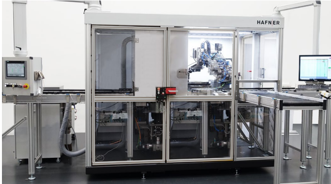
La máquina de medición y comprobación de discos de freno para camiones permite una inspección integral, detecta los defectos más pequeños y mide con precisión diámetros, longitudes y tolerancias de forma.
