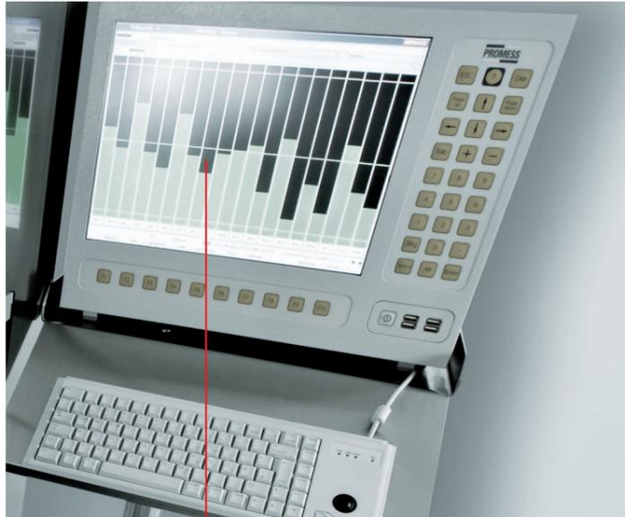
Der Messrechner übernimmt neben der Messdatenauswertung und -darstellung auch die Steuerung sämtlicher Bewegungsabläufe. Einflüsse durch verändernde Werkstück- und/oder Umgebungstemperatur werden durch eine Temperaturkompensation ausgeglichen.
