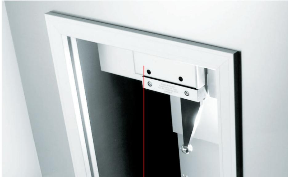
Die Linearachsen tragen ein der Messaufgabe entsprechendes Antastelement und ermöglichen so eine funktionsnahe Messung (zum Beispiel Funktionskugel des Gelenkes, um selbstzentrierend an den Kontaktwinkeln der Laufbahn anzuliegen). Die Positionserfassung der einzelnen Achsen erfolgt mittels höchstauflösender, inkrementeller Längenmesssysteme.
