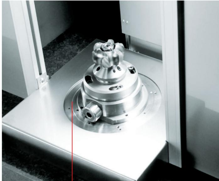
Hochpräziser, luftgelagerter Drehtisch mit Antrieb mittels Torquemotor mit Taumelfehler < 0,1  $\mu\text{m}$ , aufgebaut auf einer durch massive Schwingungsdämpfer entkoppelten Granitplatte. Auf dem Rundtisch ist eine Werkstückaufnahme aufgebaut, welche das Bauteil für die komplette Messung stabil fixiert.
