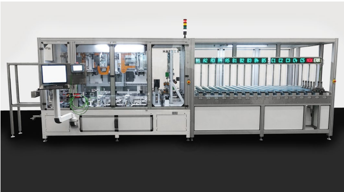
Der Messautomat für Achszapfen misst taktil und statisch Durchmesser (Zweikugelmaß, Teilkreis, Verzahnung) sowie Winkelteilungen.
